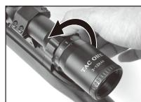
パワーセレクターを回転することで、ターゲットの拡大率を変更できます。
