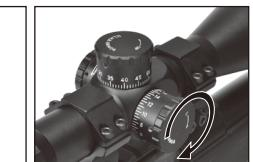
本製品は1クリックで $1/4\text{MOA}$ の移動量になるように設計されています。 $\text{MOA}$ (Minute of Angle)とは100ヤードで1インチとなる角度の単位のことです。 $1/4\text{MOA}$ をメートルに直すと「91.44mで6.35mm」の移動量ということになります。30mでは2.1mm、10mでは0.7mmとなります。
