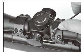
マウントベースにマウントリングを固定しているスクリューを十分に締めながら、マウントリングの上側を取り付け、各部のスクリューを締め付けます。スクリューは一箇所だけをいきなり全部締め付けるのではなく、全体が均等に締まっていくように注意してください。
