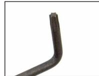
マウントベースは特殊ネジで固定されているので、必ず付属の専用レンチを使って下さい。
