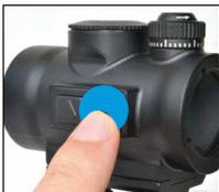
「▼」を約3秒間長押しするか、操作をせずに約5秒間経過するとOFFになり、ドットが消えます(オートオフ機能)。再びONにするとはOFFにする前と同じ明るさでドットが点灯します。
