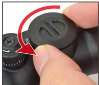
バッテリーケースの蓋を反時計回りに回して外します。指で回せるようになっていますが、きついときはコインなどを使って回して下さい。
