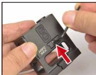
本体左側面にあるロッキングバースクリュウを、付属のマウント用レンチを使って緩めることで、本体とマウントベースが分解できるようになります。
