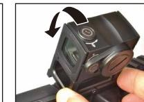
レールの溝と底面にある四角い突起の位置を合わせて、右側から被せるよう位置を合わせて、右側から被せるよう
