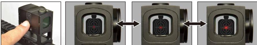
①「▲」または「▼」のスイッチ(どちらでもOK)を押すとドットが点灯します。②「▲」を押すことでドットは明るく、「▼」を押すことでドットは暗くなります。明るさは10段階に調整できます。「▼」を約3秒間長押しすることでドットは消えます。ドットの明るさは記憶されますので、次にスイッチを入れたときは消灯時と同じ明るさでドットが点灯します。
