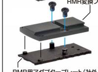
①まずRMR変換プレートを付属する取り付けネジ2本を使ってアダプタープレートに固定します。②次にRMR変換プレートにARP2本体を固定します。
