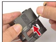
本体左側面にあるロックングバースクリューを、付属のマウント用レンチを使って緩めることで、本体とマウントベースが分解できるようになります。
