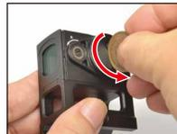
コイン等を使用して、バッテリーハウジングの蓋を反時計回りに回して開けます。
