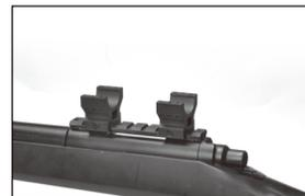
まず、マウントリングの下側のみを、銃のマウントベースに取り付けます。この段階では仮固定なので、マウントリングの固定スクロウは軽く締めるだけでOKです。
