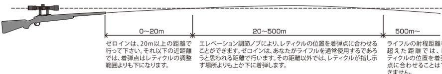
ゼロインは、20m以上の距離で行って下さい。それ以下の近距離では、着弾点はレティクルの調整範囲よりも下になります。
