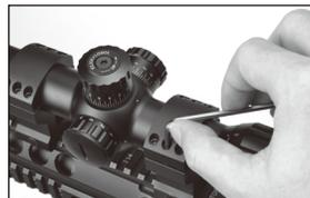
マウントベースにマウントリングを固定しているスクロウを十分に締めてから、マウントリングの上側を取り付け、各部のスクロウを締め付けます。スクロウは一面所だけいきなり全部締め付けるのではなく、全体が均等に締まっていくように注意してください。
