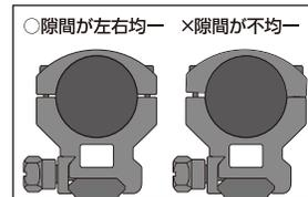
マウントリングが正しく取り付けられた場合、左図のように上下マウントリングの間には左右均等な隙間が空くように作られています。もし左図のように左右の隙間が不均一になっているようでしたら、スクロウを緩めてから左右均等になるように締め直してください。
