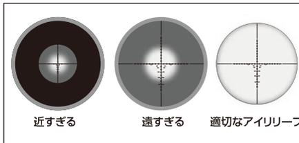
**アイリリーフとは**……スコープは目と接眼レンズの間に、ある程度の距離を置いての状態で使用します。その距離をアイリリーフと呼びます。近すぎて遠すぎて、正しい照準ができなくなります。構えた時に適切なアイリリーフが取れるようにスコープを取り付けてください。
