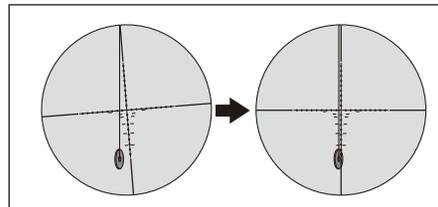
レティクルの水平・垂直を合わせます。銃を平らなところに置いた状態で垂直なもの(コインを吊り下げた糸など)をスコープで見て、糸とレティクルの縦の線が揃うようにする方法があります。
