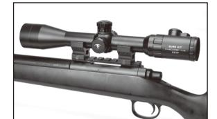
スコープをマウントリングに載せ、前後位置などが適切になっているかどうかを確認します。実際に銃を構えてみて、適切なアイリーフが取れるかどうかを確認します。
