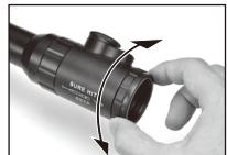
遠くを見た状態でレティクルがクリア見えるように、ディオフターを回して調節します。
