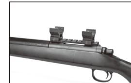
まず、マウントリングの下側のみを、銃のマウントベースに取り付けます。この段階では仮固定なので、マウントリングの固定スクリュウは軽く締めるだけOKです。
