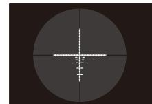
スイッチを押すと、レティクルの中心部分が赤く発光します。明るさは8段階に調節できます。
