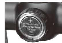
SUREHIT 1624IRは、CR2032リチウム電池を1個使用します。出荷時の電池はテスト用のため、寿命が短い場合があります。
