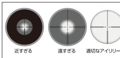
**アイリーフとは**…スコープは目と接眼レンズの間に、ある程度の距離を置いた状態で使用します。その距離をアイリーフと呼びます。近すぎても遠すぎても、正しい照準ができなくなります。構えた時に適切なアイリーフが取れるようにスコープを取り付けてください。
