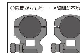
マウントリングが正しく取り付けられた場合、左図のように上下マウントリングの間には左右均等な隙間が空くように作られています。もし左図のように左右の隙間が不均一になってしまっているようでしたら、スクリュを緩めてから左右均等になるように締め直してください。
