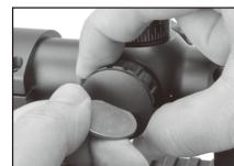
電池の交換方法です。まずロータリースイッチが回らないように指で抑えながら、コインなどを用いてバッテリーキャップを反時計方向に回して外します。
