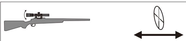
遠くを見た状態でレティクルがクリッピング見えるように、ディオプターを回して調節します。
