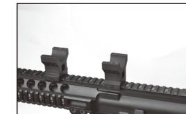
まず、マウントリングの下側のみを、銃のマウントベースに取り付けます。この段階では仮固定なので、マウントリングの固定スクリュは軽く締めるだけOKです。
