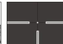
ロータリースイッチを回転させると、中心にあるドットと左右・下方のレティクルが赤く発光します。明るさは11段階に調節できます。
