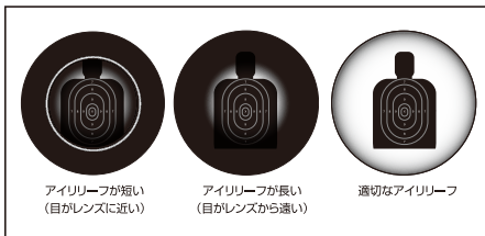
アイリリーフが短すぎたり長すぎたりすると視界が狭くなり適切な照準ができません。マグニファイヤーの枠全体に視界が広がる適切なアイリリーフになるように取り付け位置を調整してください。
