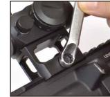
レールに装着してQDレバーをクローズ・ボジションにします。また、8mmのレンチでアジャストスクリュウを回し、締め付け具合を調節して下さい。
