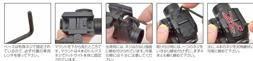
ベースは特殊ネジで固定されているので、必ず付属の専用レンチを使って下さい。
