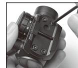
取り付け時には、一つのネジをいきなり締め付けずに、まず4本とも軽く締めて下さい。
