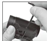
レールへの取り付け方法です。まず、ベース側面のネジを付属のトルクスレンチを使って緩めます。
