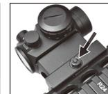
QDレバーを倒してロックしてもゆるい場合、あるいはキツすぎてレバーを倒せない(ロックできない)場合は、アジャストナットで調整して下さい。
