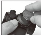
ロータリースイッチが回らないように指で押さえながら、コインなどを用いてバッテリーキャップを反時計方向に回して外して下さい。
