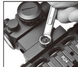
レールに装着してQDレバーをクローズ・ポジションにしたまま、8mmのレンチでアジャストスクリューを回し、締め付け具合を調節して下さい。
