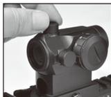
ドットの位置に弾が当たらない場合、微調整を行なうことができます。アジャストスクリューキャップを外します。
