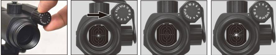
バッテリーケースの後部にあるロータリースイッチを「0」以外の位置に戻すとドットが点灯します。
