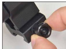
ロックナットをゆるめます。指で回せるようになっていますが、硬くて回せない場合は13mmのレンチを使ってください。
