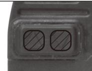
「▲▼」がモールドされている部分を強く押すことで、ドットの点灯・消灯などのボタン操作ができます。
