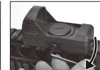
クランプスクリュウを締め付けて固定します。
