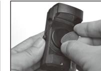
大きめのコインを使用し、バッテリーキャップを反時計回りにまわして外します。
