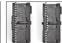
左が緩めた状態、右が締め込んだ状態です。点線で描いたラインが一直線になるようにしてください。
