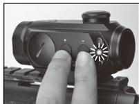
ドットが点灯した状態から、「+」と「-」のデジタルスイッチを両方同時に4秒間長押しすることでドットを消灯することができます。1時間操作が行われなかった場合は自動で消灯します。ドットが消灯するときにはLEDインジケーターが3回点滅します。
