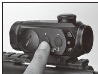
手動調光モードでは、デジタルスイッチを押すことでドットの明るさを24段階で任意に調節できます。明るさは、デジタルスイッチを短く押すことで1段階ずつ、また長押しすることで連続して明るさを変化させることができます。
