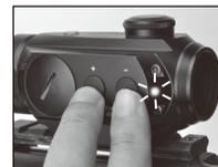
自動/手動の調光モード切り替えは、「+」と「-」のデジタルスイッチを両方向同時に1秒間だけ押すことで行ないます。モードが切り替わると、LEDインジケーターが1回だけ点滅します。
