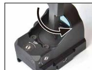
付属のアジャストツールを使用して、バッテリーハウジングの蓋を反時計回りに回して開けます。
