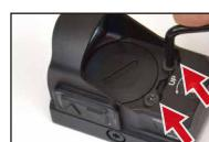
矢印で示した2本のネジを付属のトルクスレンチを使って外すことで、本体とマウントベースを分解できます。
