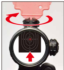
銃を固定したまま上下調節ダイヤルを「UP」の方向に回すと、着弾位置は変わらず、レンズを通して見える像が上に移動します。
