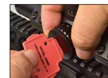
電池の交換方法です。まずロータリースイッチが回らないように指で抑えながら、コインなどを用いてバッテリーキャップを反時計方向に回して外します。
