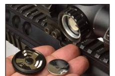
TACONE 12424 IRは、CR2032Jチップ電池を1個使用します。なお出荷時の電池はテスト用のため、寿命が短い場合があります。
